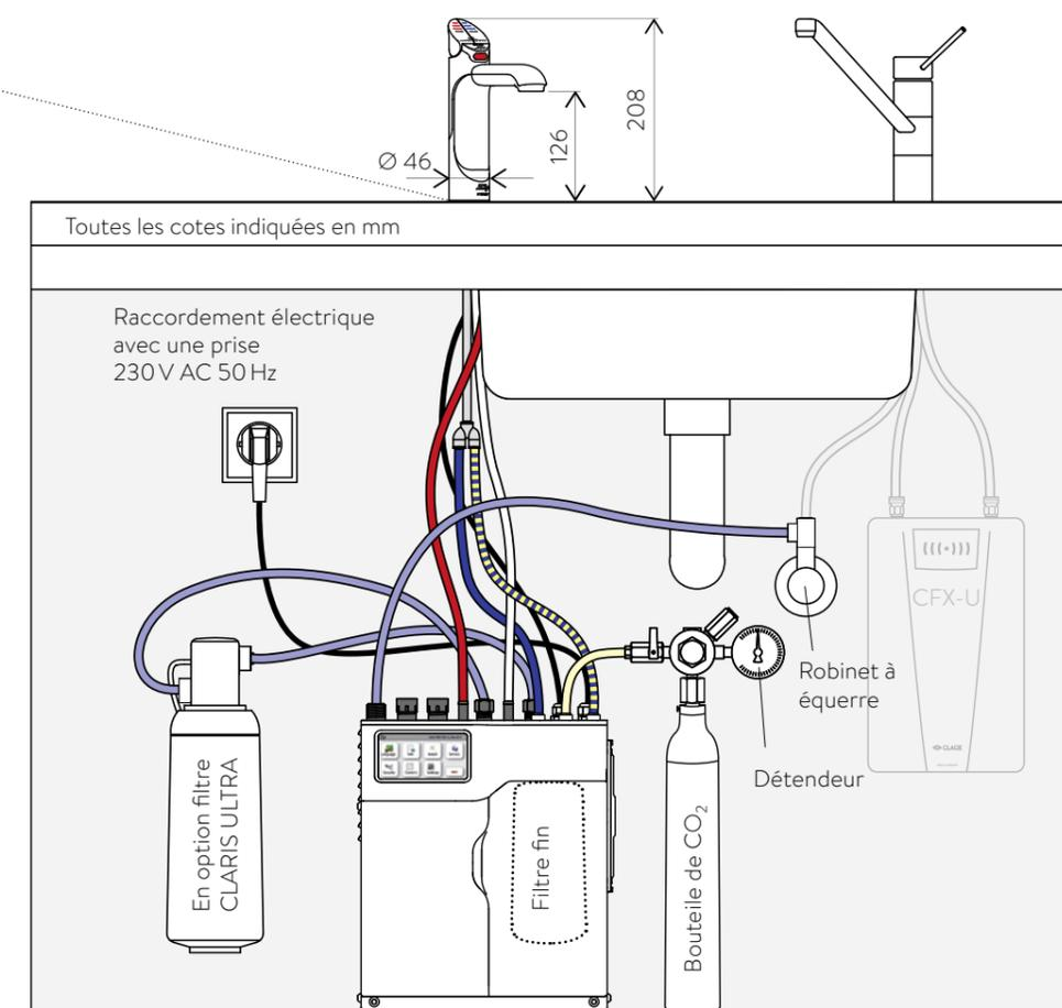
Distance de l'appareil à droite et à gauche minimum 50 mm
